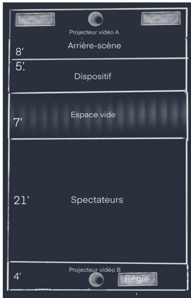
Le dispositif fait 25 pieds de large x 5 pieds de profondeur x 8 pieds de hauteur. Il est composé d'une structure en acier et aluminium. Des panneaux de bois recouverts de toiles ignifugées et peintes complètent l'image.
